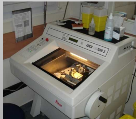
Coupes de 10 \mu m d'épaisseur à -20°C
